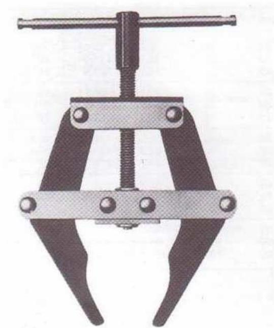
**ANTE LA DIFICULTAD QUE PUEDE SURGIR PARA UNIR LOS DOS EXTREMOS DE UNA CADENA, DADO SU LONGITUD O PESO, TENEMOS A NUESTRA DISPOSICIÓN ESTE PRÁCTICO MONTACADENAS, CON EL CUAL, CONSEGUIREMOS ACERCAR LOS DOS EXTREMOS DE LA CADENA, CON UN SENCILLO ROSCADO, QUE NOS PERMITE COLOCAR EL ESLABÓN DE EMPALME CON FACILIDAD.**
